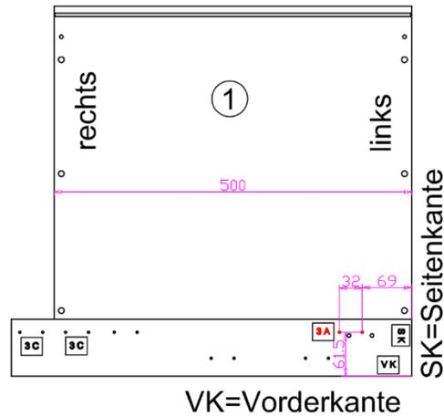
Bohrung mittels Bohrschablone 500er Korpus: Bohrung 3A
