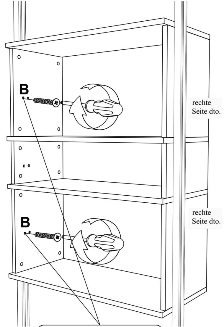
**B:** Mit der 6x35 Spaxschraube (27) durch die Seitenwand in die Profilvernut schrauben.
