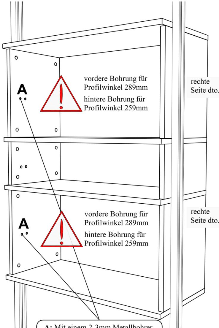
**A:** Mit einem 2-3mm Metallbohrer möglichst mittig durch die vorhandene Bohrung in der Korpusseite in tiefer liegende Profilvernut bohren.
