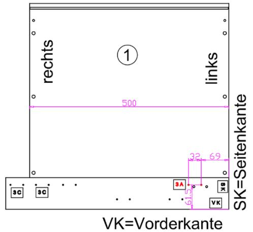
Bohrung mittels Bohrschablone 500er Korpus: Bohrung 3A
