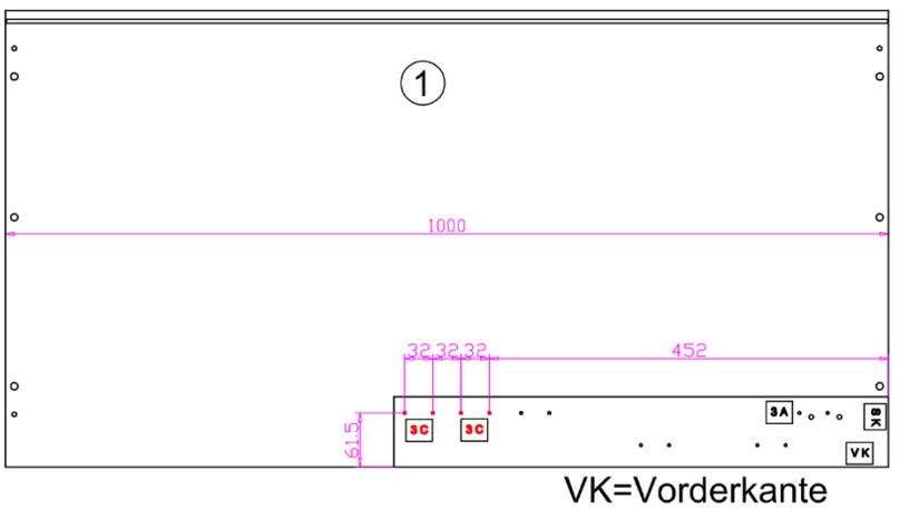
Bohrung mittels Bohrschablone 1000er Korpus: Bohrung 3C 2x
